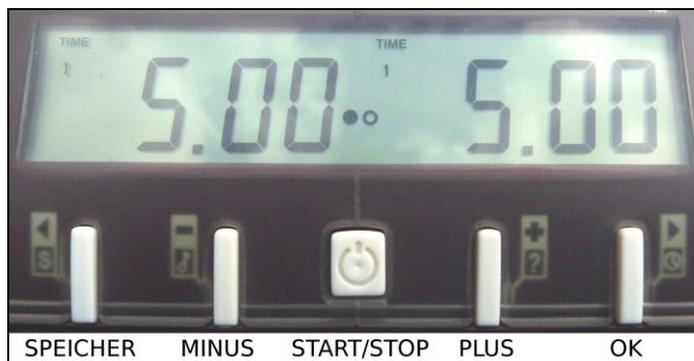
Um die Uhr für eine Partie mit einer bestimmten Zeiteinstellung zu starten, muss zunächst nach dem Einschalten der Uhr durch wiederholtes Drücken der PLUS- oder MINUS-Taste die Nummer des gewünschten Spielmodus ausgewählt werden. Mit der OK-Taste wird die Auswahl bestätigt. Mit der mittleren START/STOP-Taste wird die Uhr für die Schachpartie gestartet.
